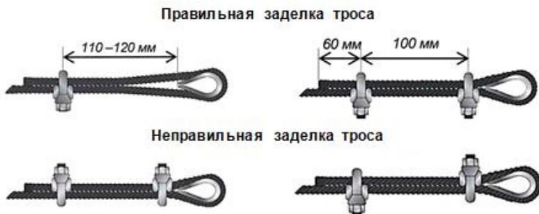
Рисунок 5. Заделка троса
